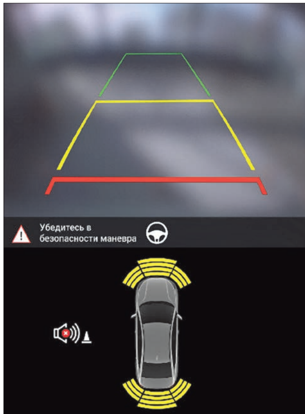
Рис. 19. Зоны обнаружения препятствий в «Режиме парковки» (в варианном исполнении с камерой заднего вида)
