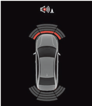
Рис. 24. Зоны обнаружения препятствий в «Режиме маневрирования»
