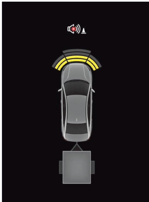
Рис. 29. Режим парковки с выбранной опцией «Прицеп» без камеры заднего вида
