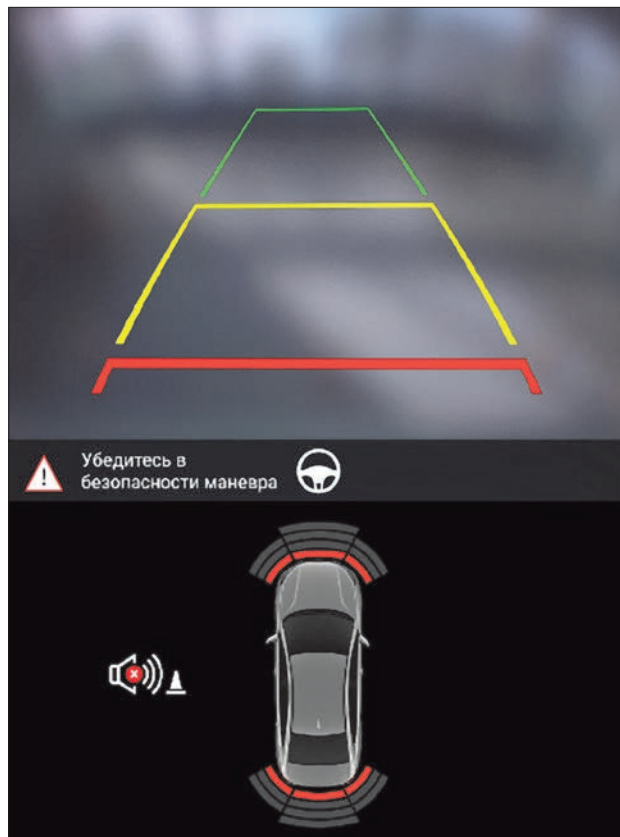
Рис. 21. Зоны обнаружения препятствий в «Режиме парковки» (в варианном исполнении с камерой заднего вида)
