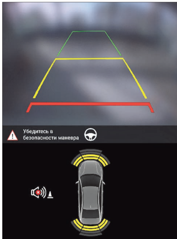
Рис. 20. Зоны обнаружения препятствий в «Режиме парковки» (в варианном исполнении с камерой заднего вида)
