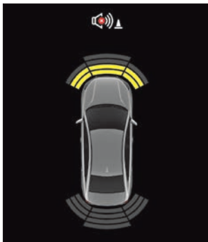
Рис. 23. Зоны обнаружения препятствий в «Режиме маневрирования»
