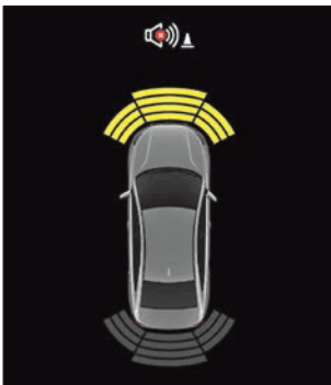
Рис. 22. Зоны обнаружения препятствий в «Режиме маневрирования»
