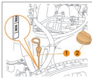
Рис. 34. Проверка уровня масла в картере двигателя
