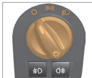
Рис. 14а. Переключатель наружного освещения
