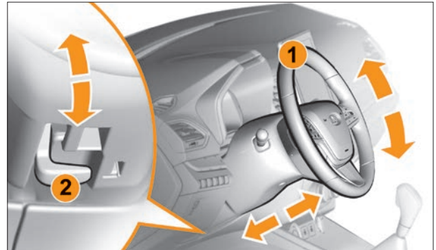
Рис. 3.4.1. Регулировка положения рулевого колеса
