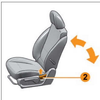
Рис. 2.1.2. Регулировка спинки переднего сиденья
