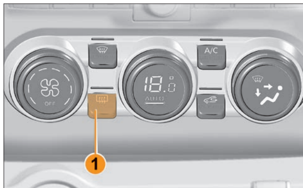
Рис. 3.11.6. Выключатель обогрева наружных зеркал (в варианном исполнении)
