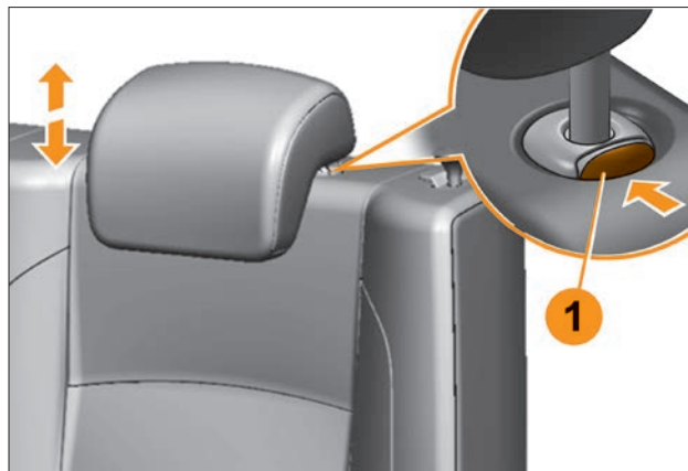
Рис. 2.2.1. Регулировка подголовников сиденья второго ряда
