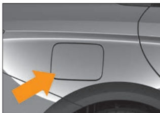
Рис. 5.18.1. Открывание крышки лючка
