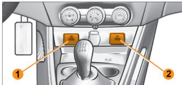
Рис. 4.4.4. USB-розетки 5 В для водителя и переднего пассажира
