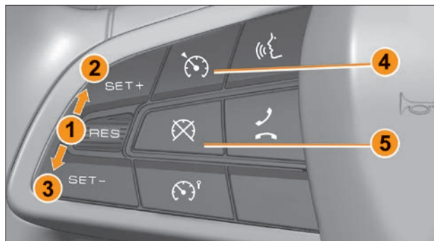
Рис. 5.12.1. Кнопки управления функцией «Круиз-контроль»
