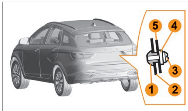
Рис. 5.1.2. Установка заднего номерного знака
