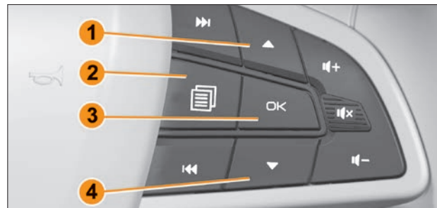
Рис. 3.3.2. Кнопки управления комбинацией приборов (в варианном исполнении)
