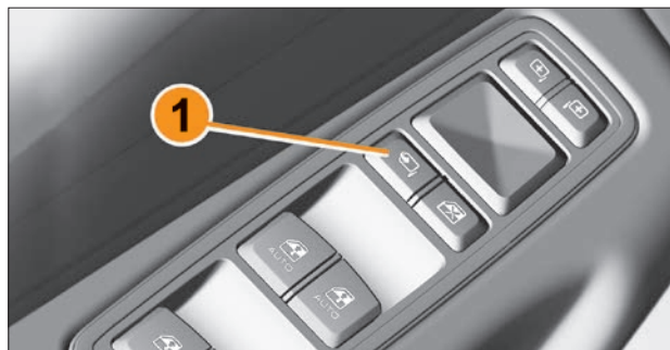
Рис. 3.11.4. Кнопка управления складыванием наружных зеркал (в варианном исполнении)
