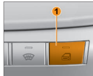
Рис. 1.3.2. Кнопка блокировки/разблокировки замков дверей
