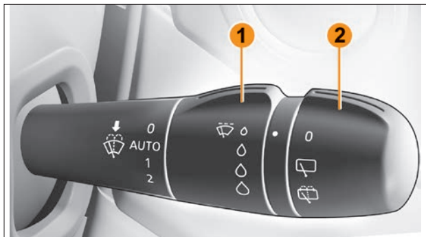
Рис. 3.9.6. Колец управления на правом рычаге подрулевого переключателя (в варианном исполнении)
