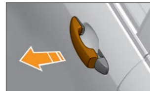
Рис. 1.4.1. Открытие боковых дверей снаружи
