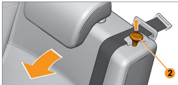
Рис. 2.2.6. Ручка фиксатора спинки сиденья второго ряда
