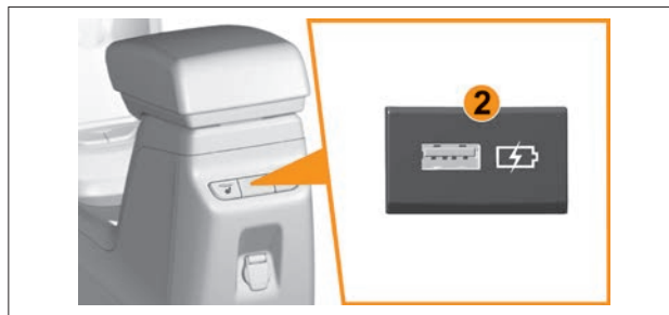
Рис. 4.4.6. USB-розетка 5 В для задних пассажиров (в варианном исполнении)
