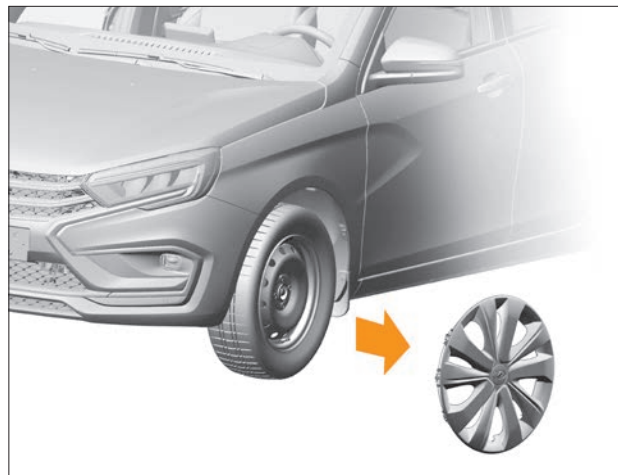
Рис. 6.8.4. Снятие декоративного колпака (в варианном исполнении)
