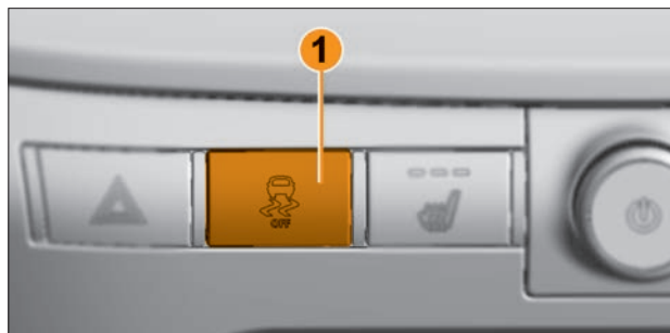
Рис. 5.14.1. Выключатель «ESC OFF» (в варианном исполнении)
