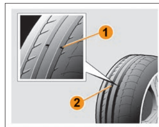
Рис. 6.8.9. Выступы-индикаторы на шинах
