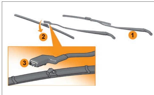
Рис. 6.7.2. Замена щеток стеклоочистителя ветрового стекла
