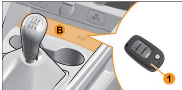
Рис. 3.5.3. Место размещения считывающего устройства
