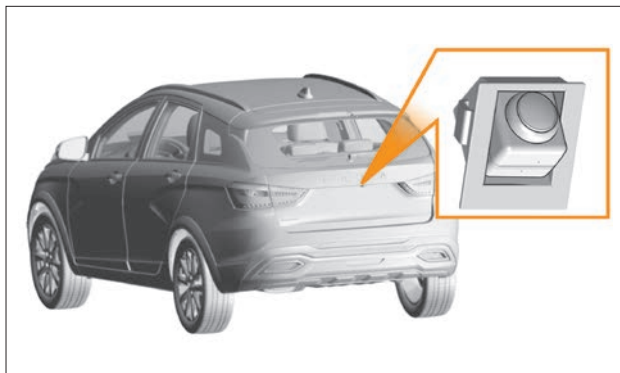
Рис. 5.16.1. Камера заднего вида (в варианном исполнении)
