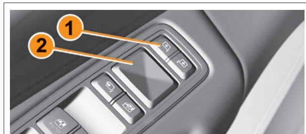
Рис. 3.11.3. Переключатель и джойстик управления электроприводом зеркал
