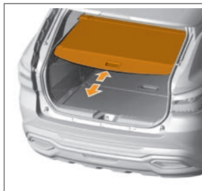
Рис. 5.8.4. Натяжная шторка багажного отделения
