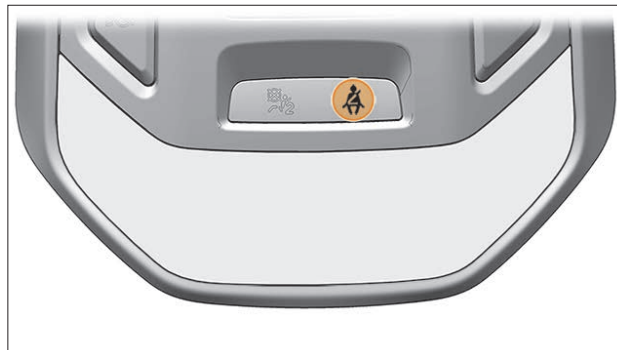
Рис. 2.4.1. Индикатор непристёгнутых ремней безопасности
