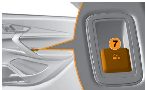
Рис. 4.1.3. Клавиша управления электростеклоподъемником с места заднего пассажира
