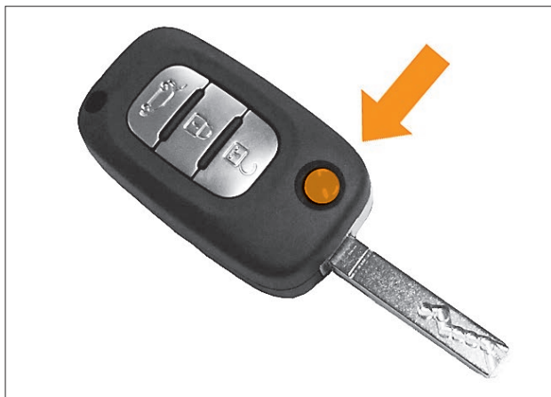
Рис. 1.1.1.1. Ключ с пультом дистанционного управления
