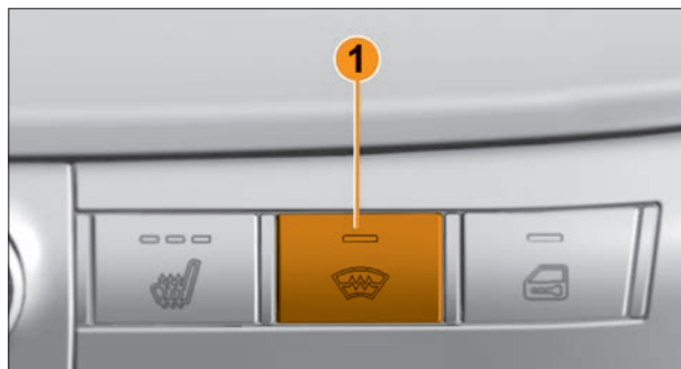
Рис. 3.12.3. Выключатель обогрева ветрового стекла (в варианном исполнении)
