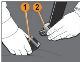
Рис. 2.4.3. Пристёгивание ремнём безопасности
