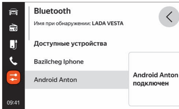
Рис. 22. Подтверждение подключения телефона
