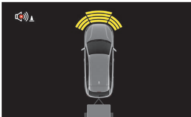
Рис. 49. Визуализация парковочного ассистента (для 8-канальной СБП без камеры заднего вида и с прицепом)
